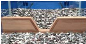
写真1 台形断面スリットの模型 台形断面スリットの定義図
