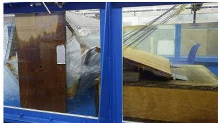
a) ドラムスクリーンの模型      b) 回転翼の詳細      c) ドラムスクリーンの周辺の流況
