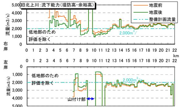
図 8 地震前後の流下能力変化 (旧北上川)
