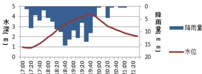
図-2 田島橋での水位と降雨量
