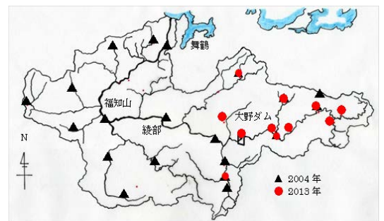
図 6 山腹崩壊発生目安の条件を 満たす雨量観測所
