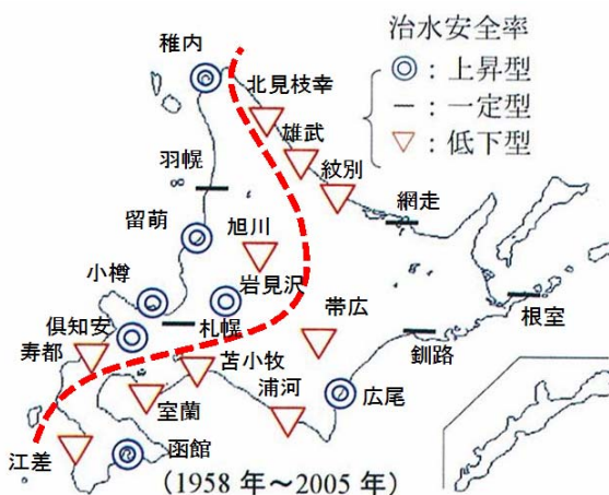
図 1 年最大日雨量の回帰直線の傾きによる治水安全率の変化傾向（佐渡・杉山 1) の図に区分線記入）
