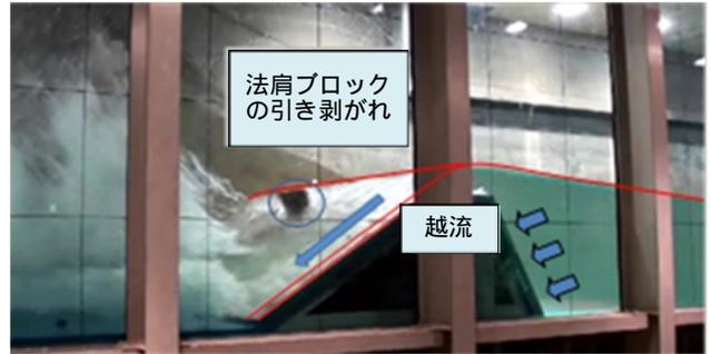
図-1 揚力による法肩ブロックの引き剥がれ現象
