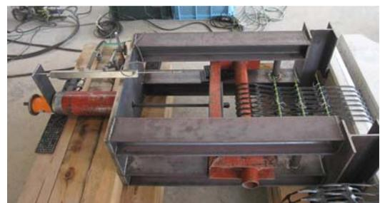
写真-3 ジオテキスタイルの連結強度試験の状況
