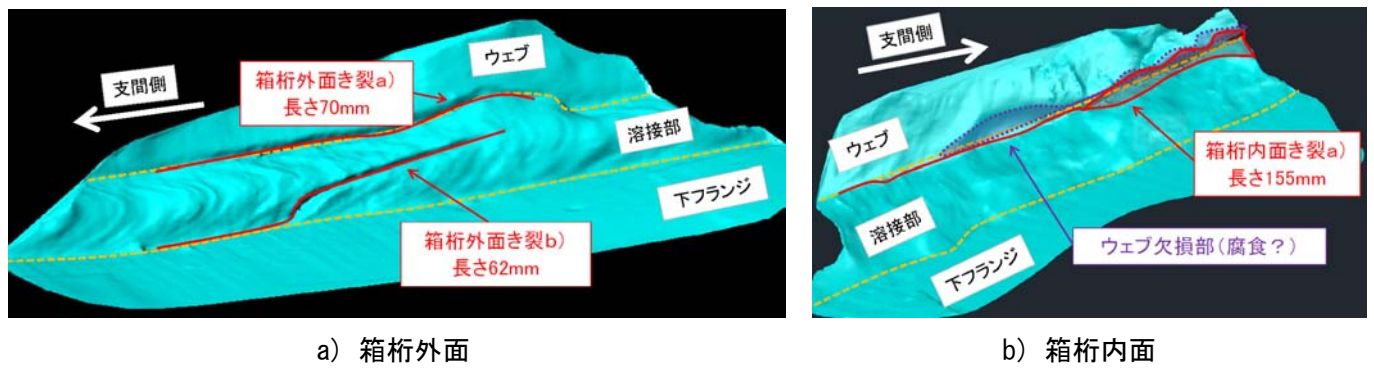
図2 三次元データ可視化によるき裂の形状表現
