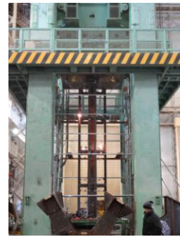
写真 3-1 載荷試験の状況 図 3-1 載荷試験図
