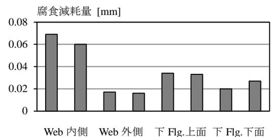
図 3 曝露試験による 1 年間の腐食減耗量
