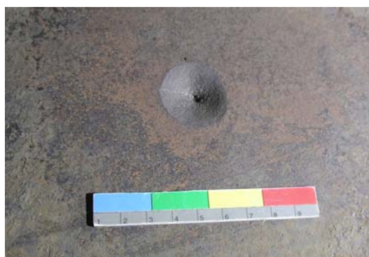
図-4 円錐形さび下の減肉状況
