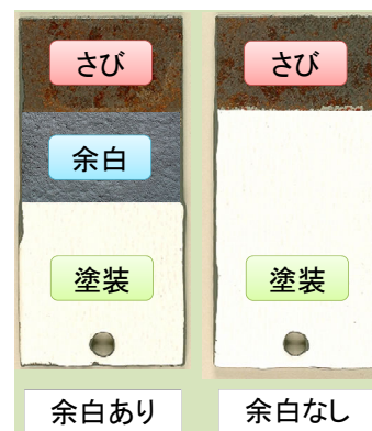
図-1 塗装端部試験片外観
