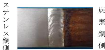
図3 溶接部近傍の腐食状況
