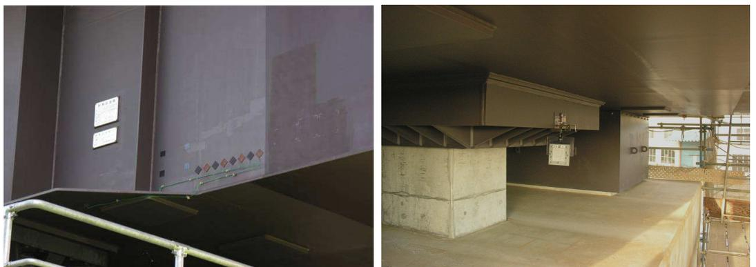
図3 試験状況 (左: ワッペン試験, 桁端部 A, 右: 飛来塩分量測定, 桁端部 B)
