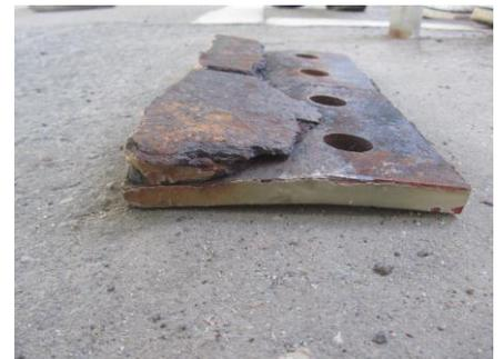
図-5 撤去直後の添接板の状況
