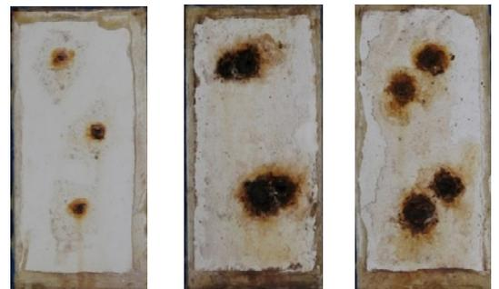
図-2 試験終了後の試験体の腐食状況
