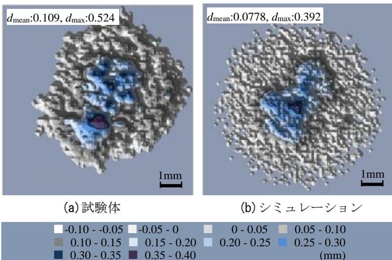
図-3 外周に凹凸を有する円形のシミュレーション
