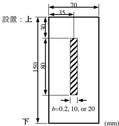
図-1 試験体と塗膜欠陥の形状・寸法
