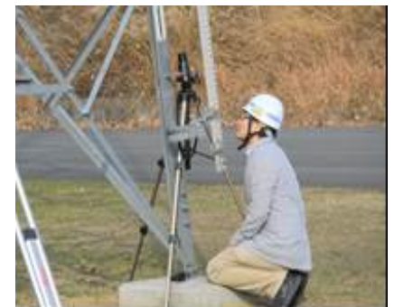
図-3 高速カメラによる計測状況
