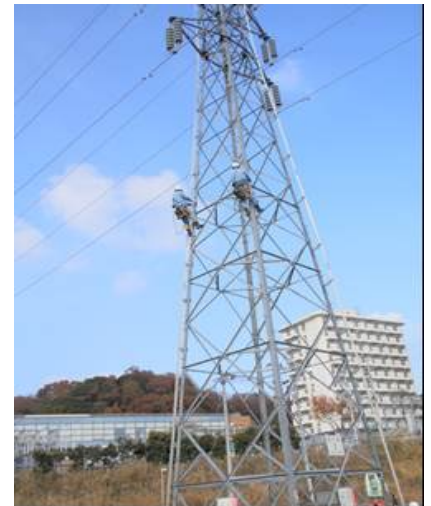
図-2 人力加振状況
