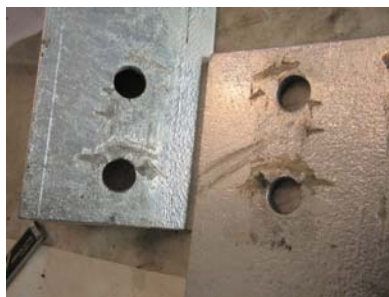
図-6 試験後のメッキ層の状況
