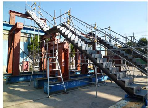
図-4 階段桁試験体
