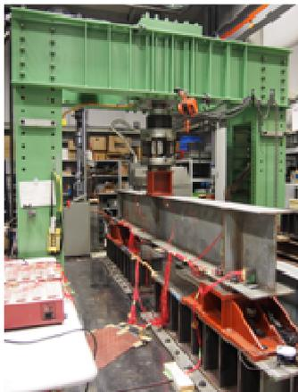
写真1 疲労試験状況
