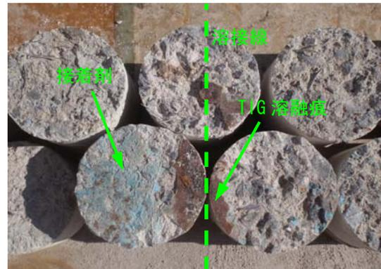
図-5 コアの破壊状況
