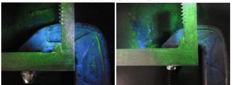
図-6 スタッドボルトの磁粉探傷試験結果
