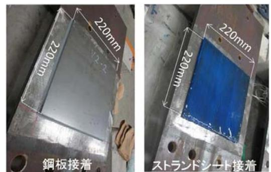
図-3 試験体裏面への当て板の接着状況
