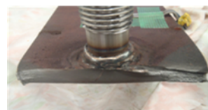
図-4 試験体の破断面(Case1-応力範囲 100N/mm 2 )
