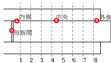
図-3 相対変位の測定位置
