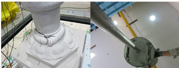
写真-1 ひび割れが発生した柱下部(春日灯籠)
