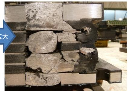
写真-2 載荷試験後の損傷状況(内部)
