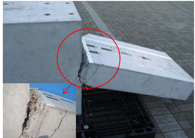
写真-2 RC1 試験体の崩壊状況
