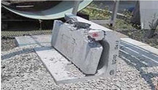
写真-3 錘の衝撃载荷（3回目）後の状況
