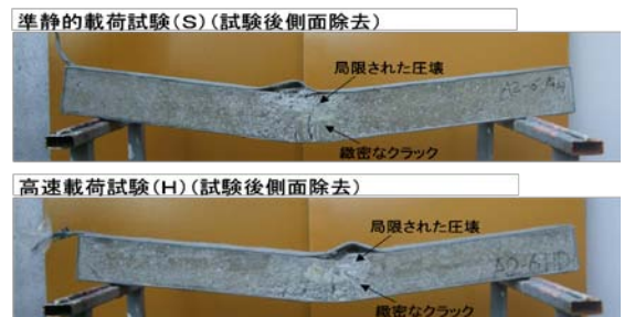
写真-5 ひび割れ発生状況（準静的载荷と高速载荷）
