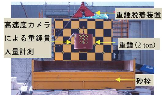
写真-1 実験状況 (S-m2-H2)
