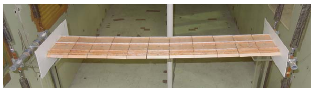
図 2 1/150 部分模型バネ支持試験設置状況
