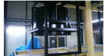
写真-1 IOWA 型竜巻シミュレータ
