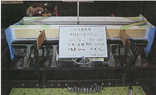
写真-3 水張り試験実施状況
