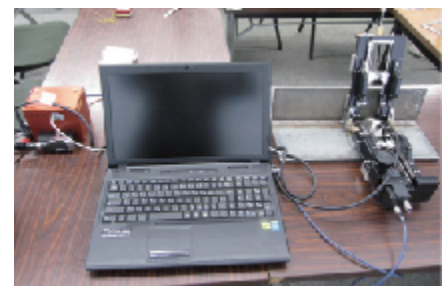
図-1 フェーズドアレイ超音波探傷システム
