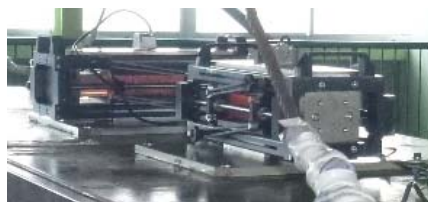
(b) 起振器設置状況
