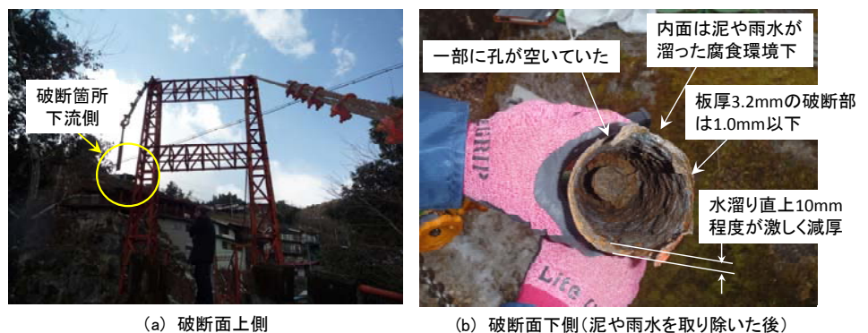
写真-3 ターンバックルの破断状況
