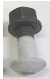
Al-Mg 溶射トルシア形高力ボルト (頭部溶射: 箱桁接合部などで使用)
