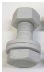
Al-Mg 溶射高力六角ボルト (全面溶射)
