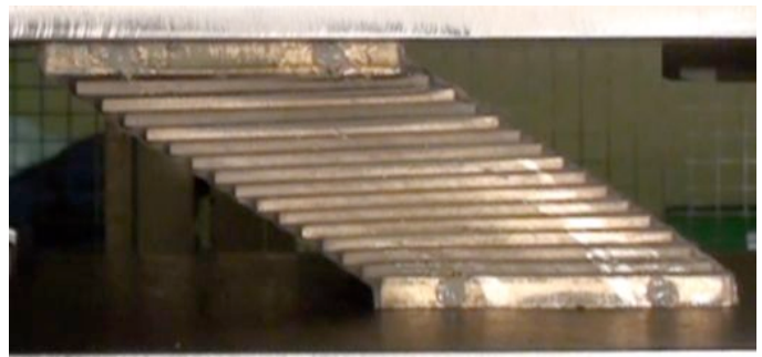
図 4 大変形領域時でのせん断状況例
