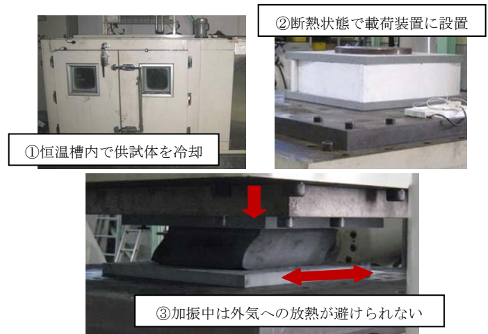
図-1 恒温槽を用いた冷却载荷実験 1)
