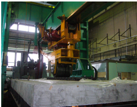
写真-2 輪荷重走行試験の荷重状況
