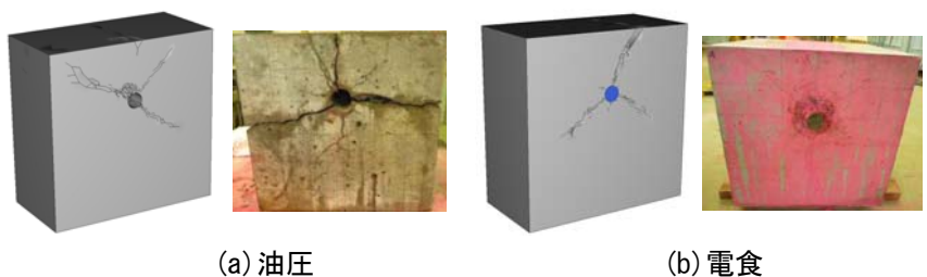
図-6 ひび割れ状況図 [左：解析結果，右：試験結果]
