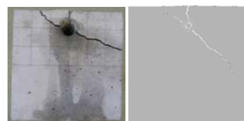
図-5 ひび割れ性状 (左: 実験, 右: 解析)
