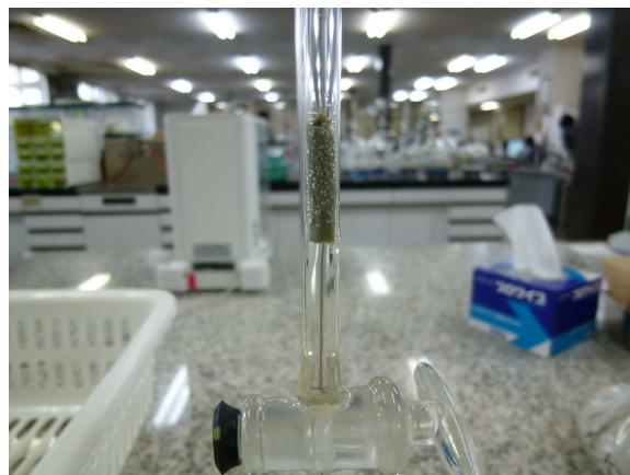
写真-1 塑性限界の試料体積測定方法
