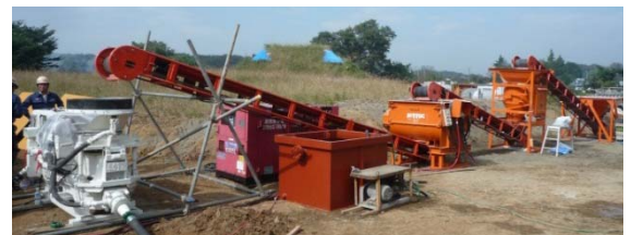
図-2 使用した吹付け機(全景)
