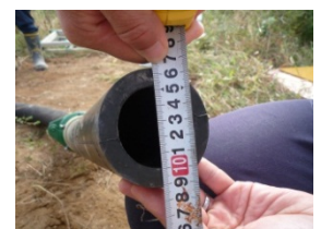
図-4 ノズル径φ52mm
