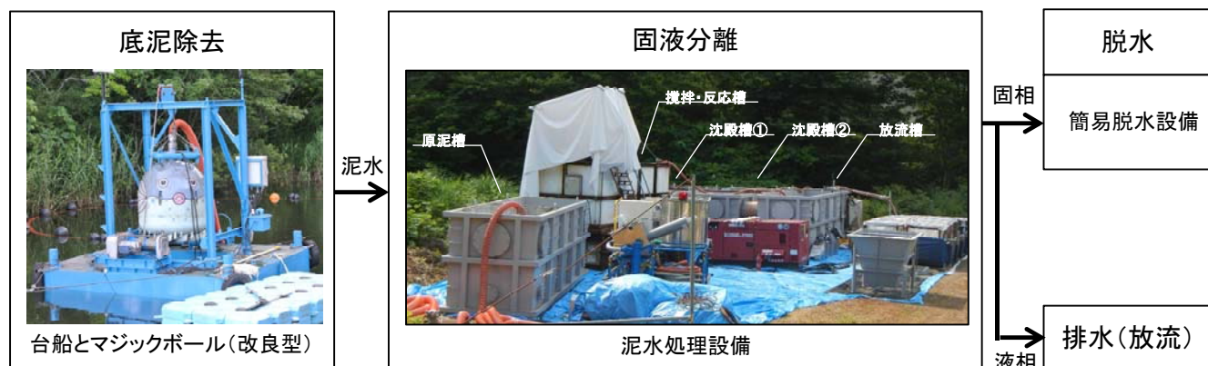
図-2 底泥除去システムの構成
