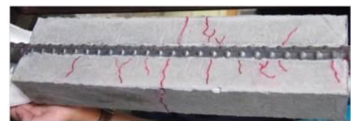
図-7 半割供試体を用いた両引き試験実験結果
