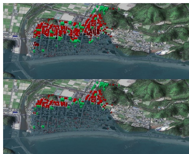
図-1 津波遡上解析結果(上: 耐力大, 下: 耐力小)
