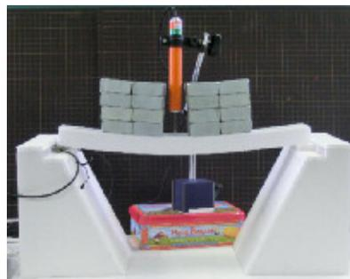
写真-5 桁高 30 mmのたわみ
