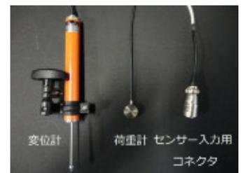
写真-2 変位計・荷重系
