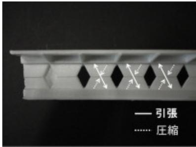
写真-4 構造モデルのひずみ
